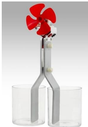
Ryc. 3. Przyrząd do obserwacji zjawiska Peltiera i Seebecka
