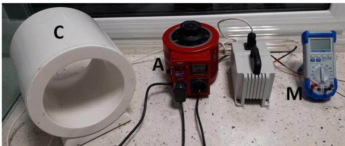
Ryc. 1. Zestaw doświadczalny: cewka o średnicy 20 cm - (C), autotransformator, którym regulujemy wielkość napięcia zasilającego cewkę (A) oraz miernik uniwersalny (M), którym mierzymy wartość natężenia prądu elektrycznego płynącego przez uzwojenia cewki.
