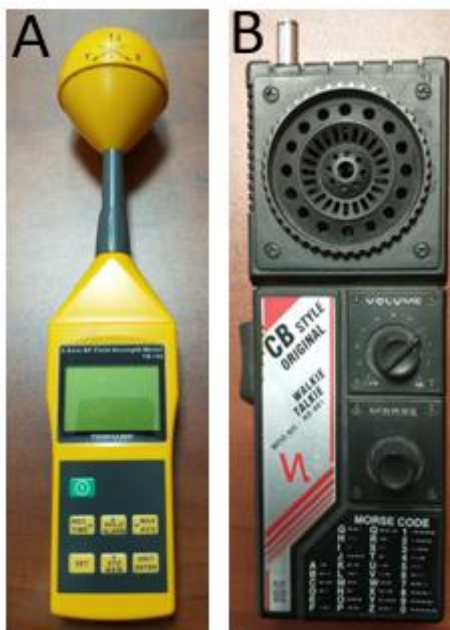
Ryc.4. Urządzenia wykorzystywane w pomiarach składowej elektrycznej PEM z zakresu radiowego: miernik TENMARS TM-196 (A), krótkofalówki- Walkie Talkie CB (B)
