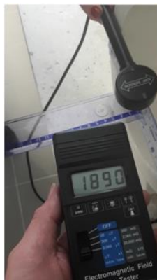
Ryc. 3. Ocena zależności pola magnetycznego od odległości od źródła
