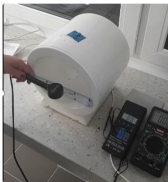
Ryc. 2. Ocena zależności wartości pola magnetycznego od natężenia prądu
