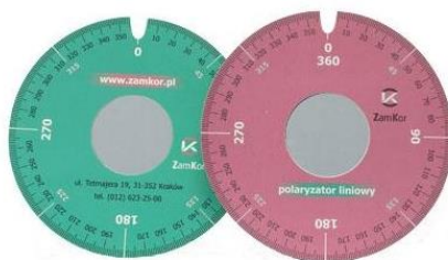
Ryc. 2. Polaryzatory liniowe oprawionych w kartonowe ramki z podziałką kątową.
